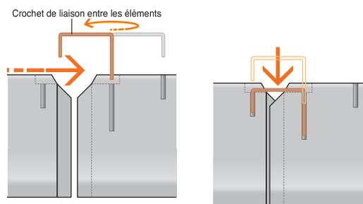
Détail assemblage crochet de liaison en acier DN 30
