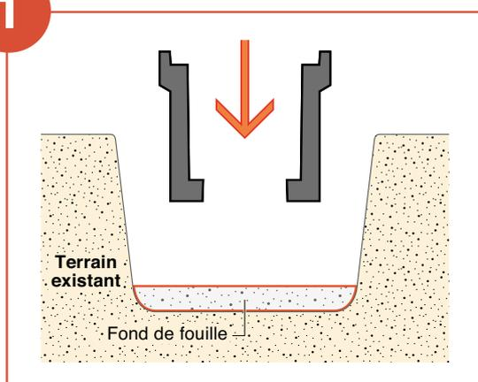
**Dressage d'un lit de sable ou d'une assise bétonnée** selon la nature du sol pour la mise à niveau
